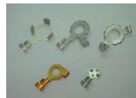
端子（ワイヤーハーネス） 材質：黄銅、SUS 板厚：0.5t～ 表面処理： Snメッキ（フープメッキ、 ラックメッキ）
