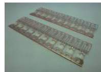
リードフレーム 材質：Cu、Cuアロイ材 板厚：0.5t、0.5t×1.3t 表面処理： Niメッキ（フープメッキ） Agメッキ（フープメッキ） Auメッキ（フープメッキ）
