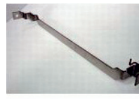
異形材プレス製品 材質：Cu 板厚：0.5t×1.3t 1.0t×3.0t、etc 表面処理： Niメッキ（フープメッキ、 ラックメッキ）
