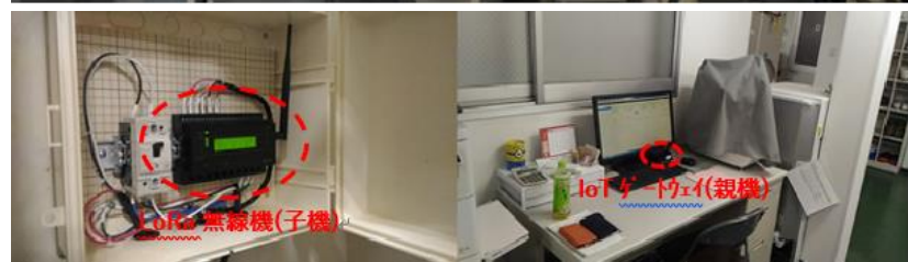
写真3(左) 装置近くの壁面に設置されたLoRa無線機(子機)の様子 写真4(右) 別室に設置されたLoRa無線機対応IoTゲートウェイ(親機)とモニターの様子
