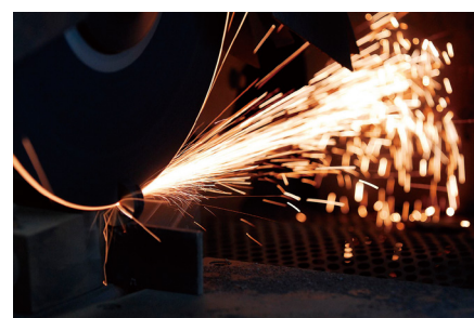
高速切断機による切断
