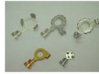
端子（ワイヤーハーネス） 材質：黄銅、SUS 板厚：0.5t～ 表面処理： Snメッキ（フープメッキ、ラックメッキ）
