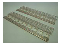
リードフレーム 材質：Cu、Cuアロイ材 板厚：0.5t、0.5t×1.3t 表面処理： Niメッキ（フープメッキ） Agメッキ（フープメッキ） Auメッキ（フープメッキ）
