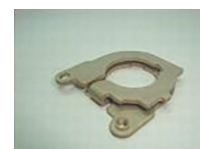
車載用プレス製品 (HV、EV) 材質：Cu、黄銅、アルミ 板厚：0.3t～3.0t 表面処理： Niメッキ（フープメッキ、 ラックメッキ、パレルメッキ） Snメッキ（フープメッキ、 ラックメッキ、パレルメッキ）
