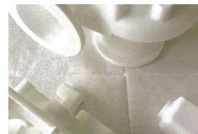
粉末焼結積層造形による ロストワックス用消失模型
