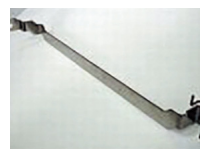
異形材プレス製品 材質：Cu 板厚：0.5t×1.3t、 1.0t×3.0t、etc 表面処理： Niメッキ（フープメッキ、 ラックメッキ）
